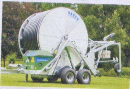
*Bei der Arbeit senkt sich die Trommelhalterung auf den Boden ab.*
